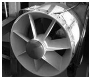
Рис. 4. Вид мини-ГЭС StrafloMatrix
