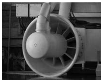
Рис. 3. Вид мини-ГЭС HYDROMATRIX
